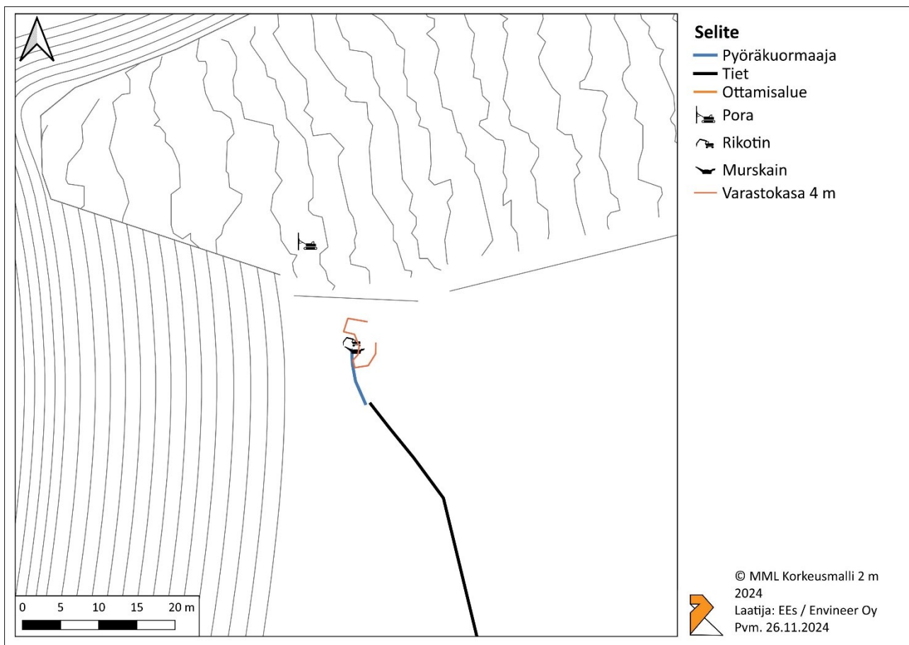
Kuva 5. Loppuvaiheen mallissa rikottimen ja murskaimen itäpuolelle sijoitetut maa- ja varastokasat.
